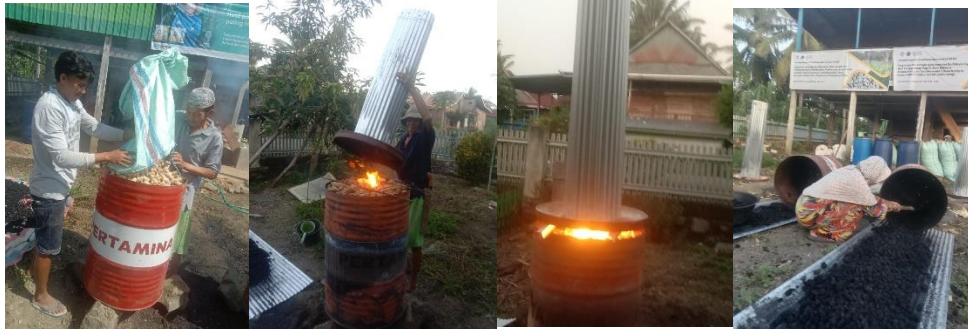
Gambar 8. Proses pembakaran tongkol jagung menggunakan teknologi TLUD
